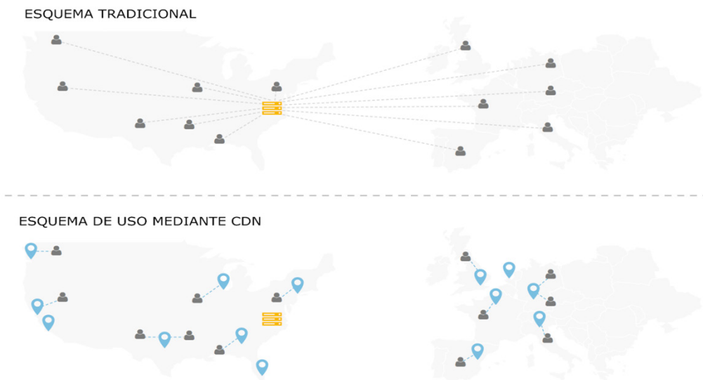
Figura 1 - Esquema de funcionamiento de una red CDN
