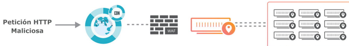
Figure 17 - Système de protection WAF basé sur le CDN
